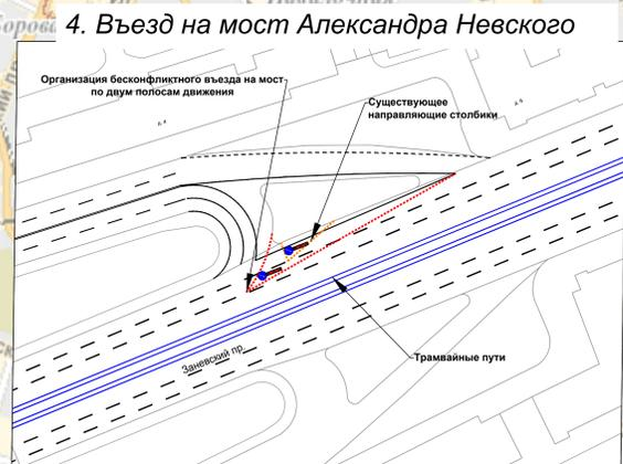
Обеспечить приоритет левого поворота путем работы объекта светофорного регулирования в ручном режиме
